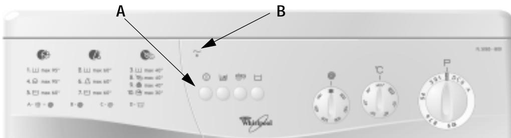
В процессе выполнения выбранной программы стирки ручка переключателя программ постепенно перемещается по часовой стрелке, проходя последовательно фазы предварительной стирки, основной стирки, полоскания и отжима. Каждое такое перемещение занимает от нескольких секунд до определенного количества минут.
