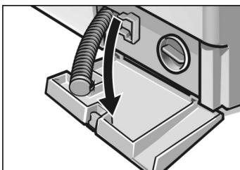
**Осторожно** снимите с конца шланга колпачок и слейте раствор моющего средства в приготовленную емкость.
