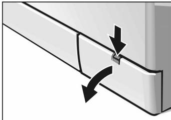
Освободите сливной шланг из держателя и извлеките его из корпуса машины.
