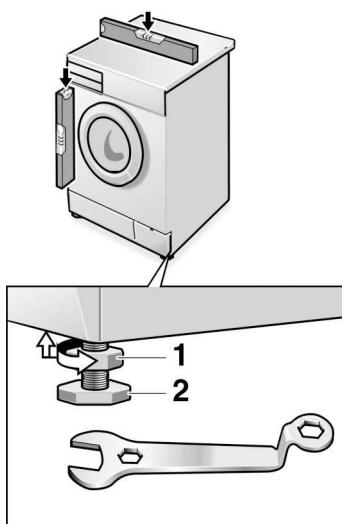
Выравнивание стиральной машины по горизонтали и вертикали проводится с помощью регулируемых по высоте ножек машины и ватерпаса:
