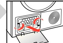
Не допускайте повреждения защитного фильтра и воздушного охладителя!
