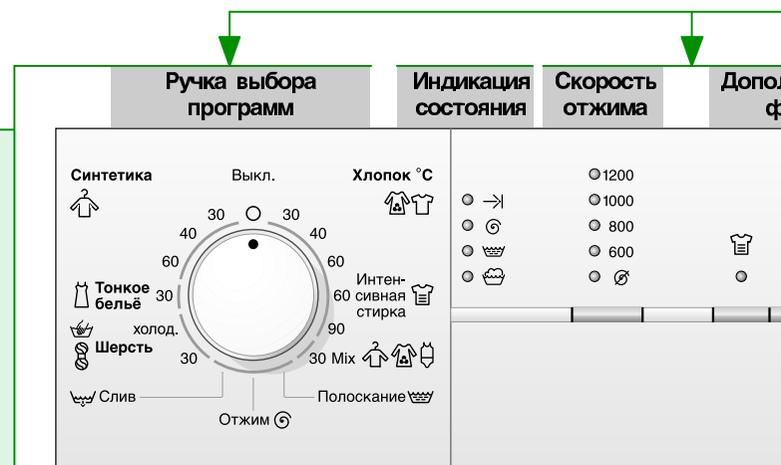
**i** Ручка выбора программ для включения и выключения машины и установки программ. Можно поворачивать в обоих направлениях.
