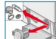
4. Очистите внутреннее пространство, резьбу крышки насоса и сам корпус насоса (крыльчатка насоса должна свободно вращаться).
