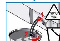
3. Осторожно отверните крышку насоса (остаточная вода!).
