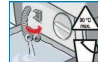
2\*. Для моделей без сливного шланга: Осторожно отвинчивайте крышку насоса, пока не начнёт выливаться вода. Когда защитная крышка наполовину наполнится, заверните пробку насоса и вылейте воду из защитной крышки. Повторяйте этот процесс, пока не сольется вся мыльная вода.
