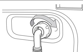
6. Включите подачу воды и убедитесь, что нет протечки воды из клапана подачи воды, крана или адаптера. Если есть протечка воды, повторите предыдущие действия.
