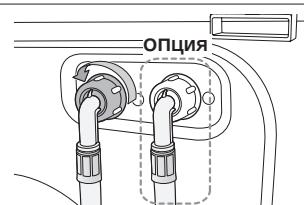
6. Включите подачу воды и убедитесь, что нет утечки воды из клапана подачи воды, крана или адаптера. Если есть утечка воды, повторите предыдущие действия.
