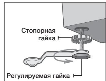
3. Когда стиральная машина будет выровнена, затяните стопорную гайку с помощью плоской отвертки.
