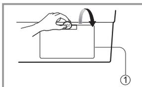
2. Выньте дренажную пробку (2), чтобы остатки воды стекли. Подставьте какой-нибудь сосуд, чтобы вода не попала на пол. Когда вода перестанет течь, откройте фильтр дренажного насоса (3), повернув его против часовой стрелки.
