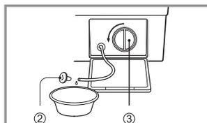
3. Выньте все посторонние предметы из фильтра (3). После чистки поверните фильтр (3) по часовой стрелке и вставьте на место дренажную пробку (2). Закройте дверцу на нижней панели.
