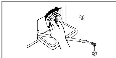
4. После чистки поверните фильтр (③) по часовой стрелке и вставьте на место дренажную пробку (②). Закройте дверцу на нижней панели.
