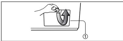
1. Откройте дверцу на нижней панели (①) при помощи монетки. Поверните дренажную пробку (②), чтобы освободить дренажный шланг.
