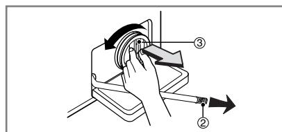
2. Выньте дренажную пробку (②), чтобы остатки воды стекли. Подставьте какой-нибудь сосуд, чтобы вода не попала на пол. Когда вода перестанет течь, откройте фильтр дренажного насоса (③), повернув его против часовой стрелки.
