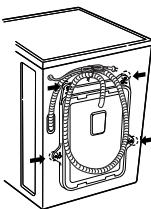
1. Для предотвращения повреждения внутренних деталей машины при транспортировке в машине закреплены 4 транспортировочных болта. Перед началом эксплуатации машины эти болты необходимо удалить вместе с резиновыми заглушками.
