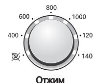
• Кнопка Отжим предназначена для выбора скорости вращения барабана при отжиме. Скорость вращения измеряется в оборотах в минуту
