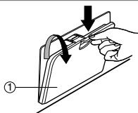
1. Откройте защитную крышку клапана слива воды, которая находится в нижнем углу. Открутите пробку сливного отверстия и вытащите шланг.
