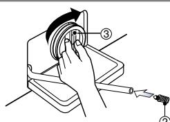
4. После чистки поверните фильтр (③) по часовой стрелке и вставьте на место дренажную пробку (②). Закройте дверцу на нижней панели.
