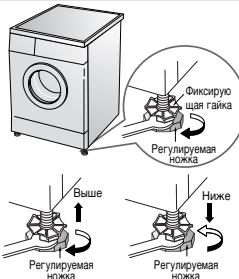
2. Если пол неровный, обеспечьте горизонтальное положение стиральной машины при помощи регулируемой ножки. (Не следует для выравнивания положения подкладывать под ножки куски древесины и т.п.)
