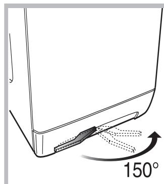
Ваша стиральная машина может быть оснащена специальными убирающимися колесами для облегчения ее перемещения. Чтобы опустить колеса и передвинуть оборудование, просто потяните за рычаг, расположенный слева под основанием машины. После установки оборудования в требуемое положение верните рычаг в исходное положение.
