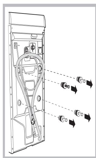
последующей транспортировке стиральной машины.
