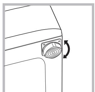
сначала ослабьте контргайку, после завершения регулировки контргайку затяните.
