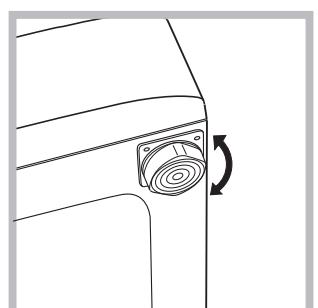
(см. рис.). Для этого сначала ослабьте контргайку, после завершения регулировки контргайку затяните.
