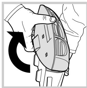
3. Чтобы получить доступ к отделениям распределителя, открепите его крышку, как показано на рис.
