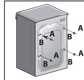
Upevnite k dnu práčky priložený protihlukový štít z vlnitého materiálu podľa obrázka.
