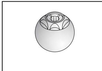
Примечание: отделение "⊗" заполняется только жидкими средствами. Машина автоматически забирает добавки на последнем полоскании во всех программах стирки.
