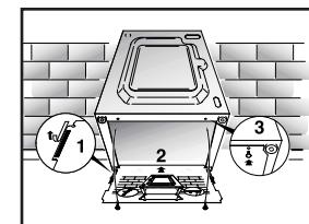
Umiestnite práčku do roviny pomocou 4 nastavovacích nožičiek:
