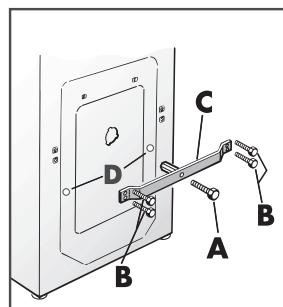
Открутите центральный транспортировочный болт (**A**), открутите 4 боковых транспортировочных болта (**B**) и снимите перекладину (**C**).
