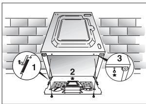
Прикрепите к дну машины дополнительную пластину с волнистой поверхностью, как показано на рисунке.
