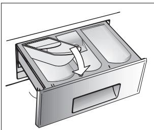
Если Вы хотите использовать жидкие моющие средства, в отделение II следует вставить специальную ванночку, прилагаемую в комплекте. Это обеспечит поступление жидкого моющего средства в барабан только в нужный момент.
