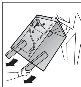
Наклоните машину вперед, достаньте пластиковые распорки; выньте, потянув вниз, полиэтиленовые мешки с полистироловыми прокладками, которые расположены по обеим сторонам.
