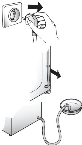
Перед транспортировкой стиральной машины или в тех случаях, когда Вы не будете пользоваться машиной в течение длительного времени, и машина будет храниться в неотапливающем помещении, необходимо слить всю воду из шлангов машины.
