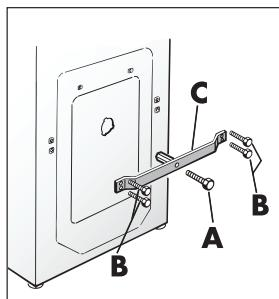
Отвинтите центральный винт **(A)**, 4 боковых винта **(B)** и снимите транспортировочную скобу **(C)**.
