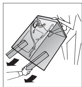
Наклоните стиральную машину вперед и удалите пластиковые мешки, в которых находятся два уплотнителя из полистирола, потянув их вниз.
