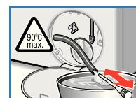
3. Снимите закрывающую пробку и слейте моющий раствор. Приготовьте соответствующую емкость.
