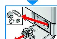
4. Очистите внутреннее пространство, резьбу крышки насоса и сам корпус насоса (крыльчатка насоса должна свободно вращаться).
