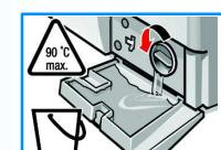
3. Осторожно отверните крышку насоса (остаточная вода!).
