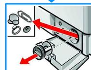
4. Проведите чистку насоса изнутри, почистите резьбу крышки насоса и его корпус (крыльчатка насоса должна свободно вращаться).
