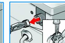
2. Присоедините шланг и проверьте места соединения на герметичность.
