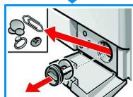
4. Проведите чистку насоса изнутри, почистите резьбу крышки насоса и его корпус (крыльчатка насоса должна свободно вращаться).
