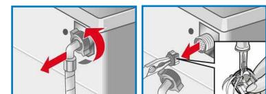
6. Подсоедините шланг и проверьте герметичность соединения.
