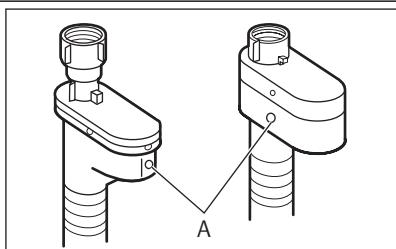
Наливной шланг оснащен устройством для защиты от протечек воды. Это устройство предотвращает протечки, которые могут иметь место по причине естественного старения шланга. О возникновении такой неисправности предупреждает появление красного сектора в окне "A". В подобном случае закройте водопроводный вентиль и обратитесь в сервисный центр для замены шланга.
