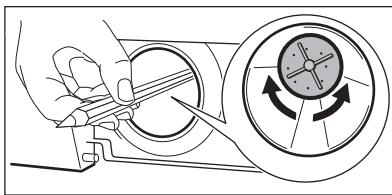
6. Установите сливную трубку на место, затем поверните фильтр и извлеките его из прибора.
