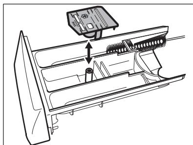
3. Снимите верхнюю часть отсека для жидкых добавок.
