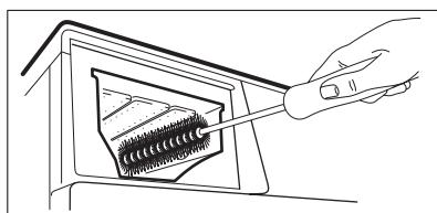
5. Очистите нишу дозатора с помощью щетки.
