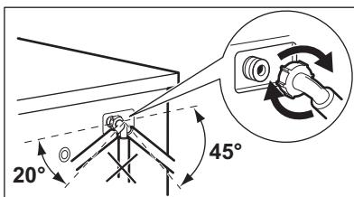
9. Очистите фильтр, находящийся под водопроводным вентилем, и вставьте его обратно в насос по специальным направляющим.
