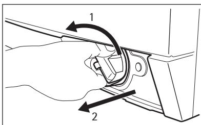
4. Нажмите на два рычажка, расположенные на сливной трубке, и потяните ее вперед, чтобы дать воде стечь наружу.
