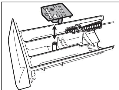
3. Снимите верхнюю часть отсека для жидких добавок.
