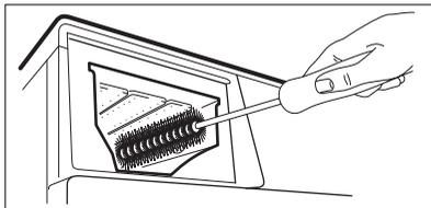
5. Очистите нишу дозатора с помощью щетки.
