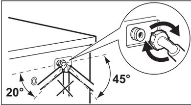
4. Снимите наливной шланг, подключенный к прибору сзади.
