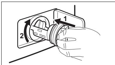
8. Очистите фильтр, находящийся под водопроводным вентилем, и вставьте его обратно в насос по специальным направляющим.
