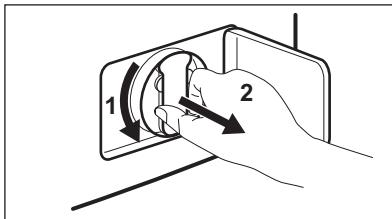
5. Установите сливную трубку на место, затем поверните фильтр и извлеките его из прибора.
