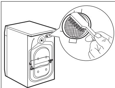
4. Снимите наливной шланг, подключенный к прибору сзади.
