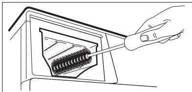
5. Очистите нишу дозатора с помощью щетки.
