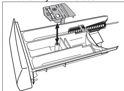
5. Прочистите щеткой все детали машины, особенно форсунки в верхней части отсека для дозатора.
