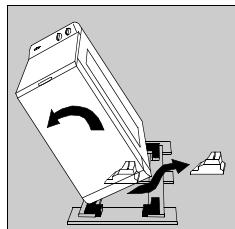
Снимите с машины всю упаковку. Наклоните машину на бок, выньте упаковку из-под мотора и поставьте машину вертикально.
