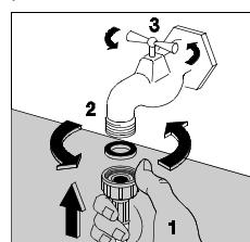
Прикрутите заливной шланг к крану подачи воды (20x27 мм), не забудьте установить прокладку, поставляемую со стиральной машиной. Откройте кран подачи воды.
