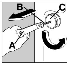
4. Отвинтить два болта (B) на задней стенке машины с помощью ключа (A) и вынуть две прокладки (C).
