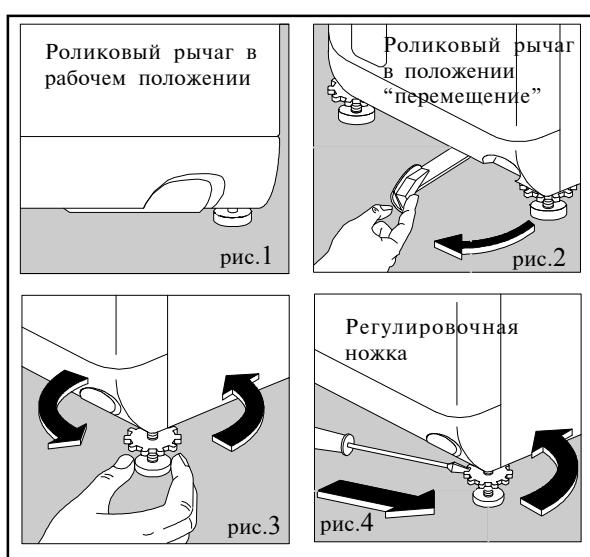
Отрегулируйте высоту ножек, как показано на рис. 4. Точная регулировка ножек сокращает вибрацию и уменьшает шум при работе стиральной машины, а также препятствует смещению машины во время работы.
