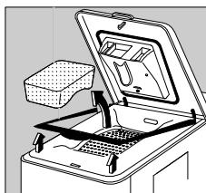
3. Откройте крышку и выньте из машины стопор из полистирола и пластиковую прокладку .
