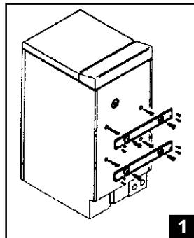
Включение машины без снятия транспортировочных болтов может вызвать ее поломку. Сохраняйте болты и втулки, которые могут Вам опять понадобиться при транспортировке машины.
