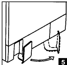
Для удобства перемещения стиральная машина снабжена четырьмя убирающимися колесами (рис. 5). Чтобы передвинуть машину, достаточно сдвинуть рычаг направо, после установки машины верните рычаг в исходную позицию. Обязательно проверьте, выровнена ли машина.
