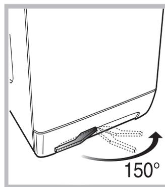
Ваша стиральная машина может быть оснащена специальными убирающимися колесами для облегчения ее перемещения. Чтобы опустить колеса и передвинуть оборудование, просто потяните за рычаг, расположенный слева под основанием машины. После установки оборудования в
