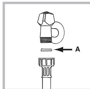
1. Вставьте прокладку A в конец заливного шланга и наверхните его на вывод водопровода холодной воды с резьбовым отверстием 3/4 дюйма (см. рис.). Перед подсоединением откройте водопроводный кран и дайте стечь грязной воде.
