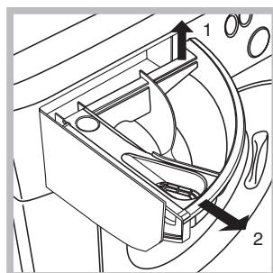
Выньте распределитель, приподняв ее и потянув наружу (см. схему).
