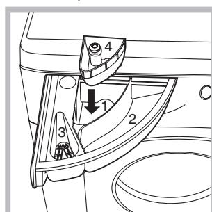
Не заливайте отбеливатель в дозатор выше отметки «макс.» на центральной шкале (см. рисунок).
