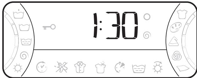
При нажатии кнопки ПУСК/СБРОС (Start/Reset) для запуска программы на дисплее показывается приблизительное время, остающееся до завершения цикла. В случае установки отложенного старта программы (пуск по таймеру, см. с. 7) дисплей будет показывать время, оставшееся до начала стирки.
